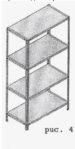
Внимание: при затягивании болтовых соединений предварительно необходимо проверить правильность геометрии конструкции (отсутствие перекосов, схожесть диагоналей).
